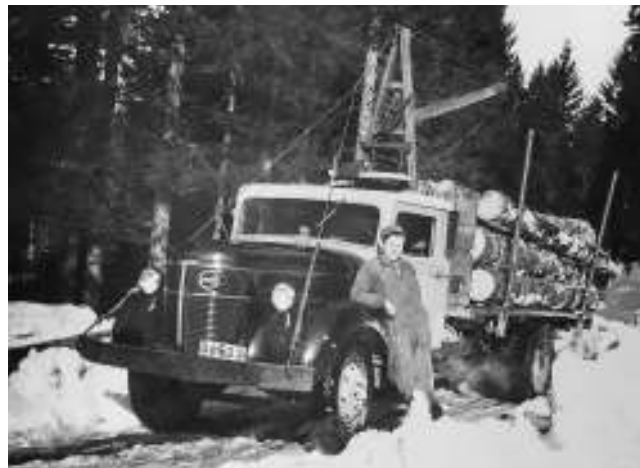
Senare utrustades lastbilen med en egentillverkad kran, designad av Gunnar och Allan tillsammans med Johan på Sandhagens verkstad i Hällevadsholm.
